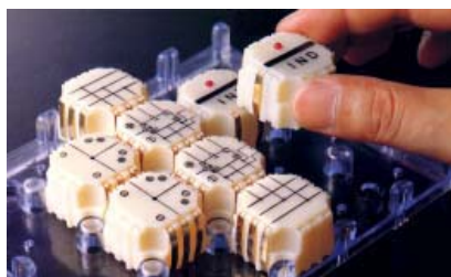
回路規模に応じて基板は 上下左右に連結可能
